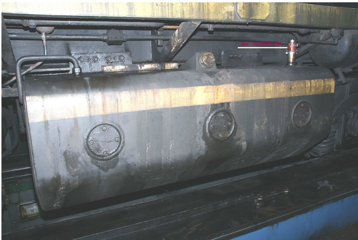
Рис. 1 - Датчик ПМП-201, установленный в бак локомотива ТЭМ-2.
