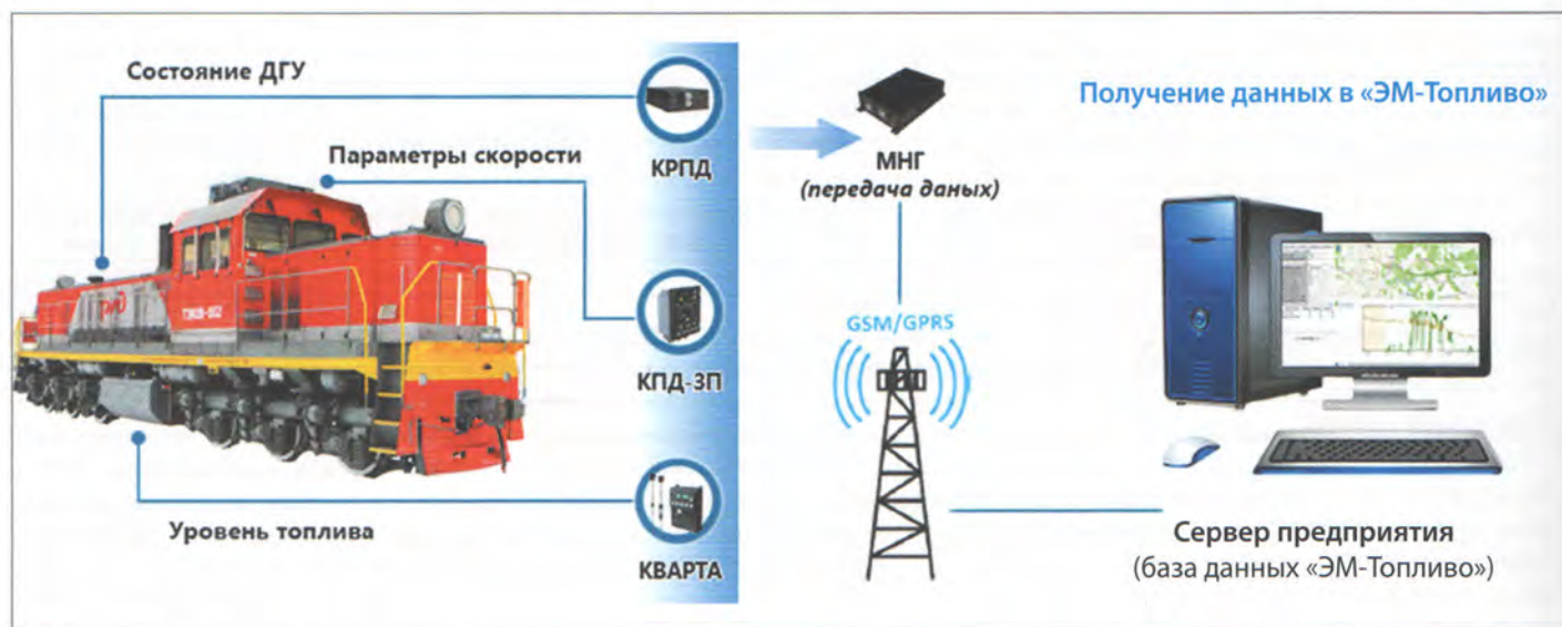
Рис. 1. Взаимодействие бортового оборудования KVARTA и программного обеспечения «ЭМ-Топливо» для автоматического учета топлива
