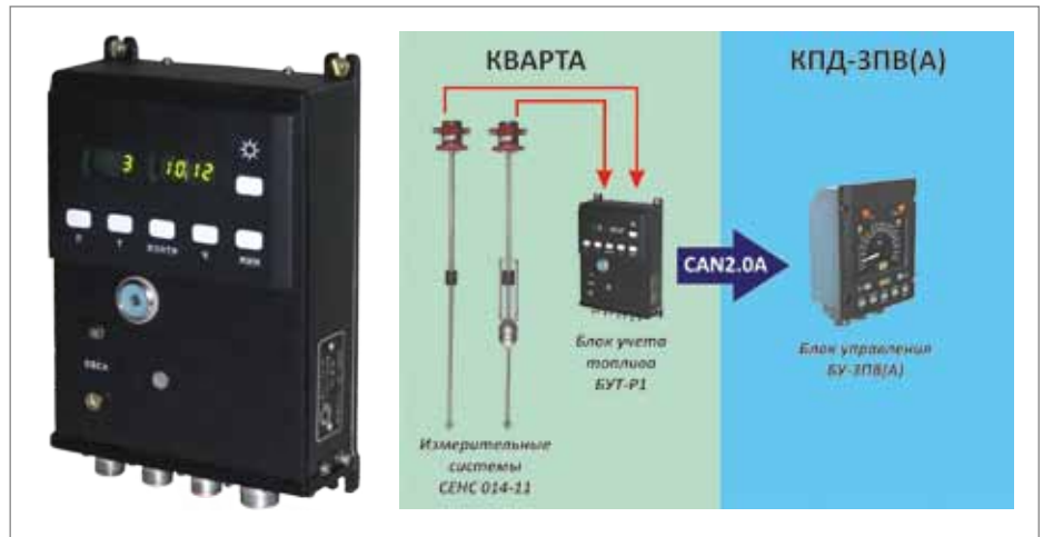
Рис. 5. Блок учета топлива БУТ-Р1: хранит данные, полученные от датчиков СЕНС 014-11, рассчитывает массу и приводит объем топлива к 20 °С, индицирует все параметры и состояние датчиков, передает данные по шине CAN2.0 А в блок управления скоростемера КПД-ЗПВ (КПД-ЗПА)
