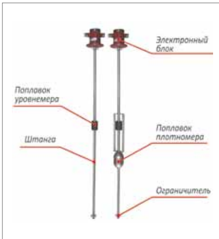
Рис. 4. Магнитострикционные поплавковые датчики СЕНС 014-11 для измерения уровня, температуры и плотности топлива
